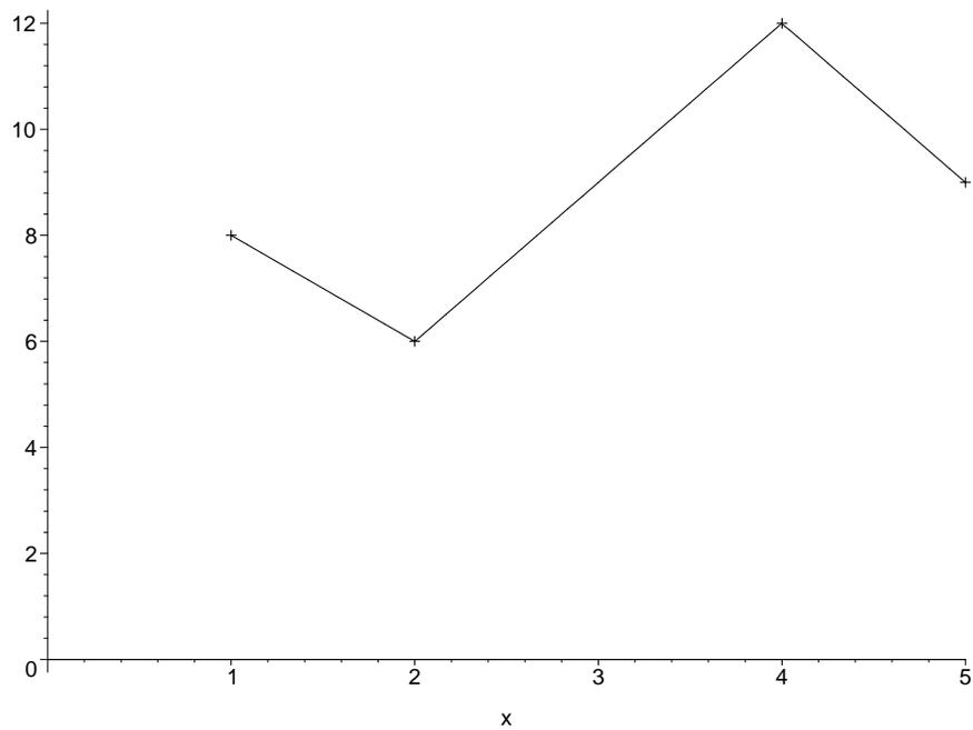
FIG. 6 – Interpolation LPM de  $f$  : l’interpolant n’est pas différentiable.
