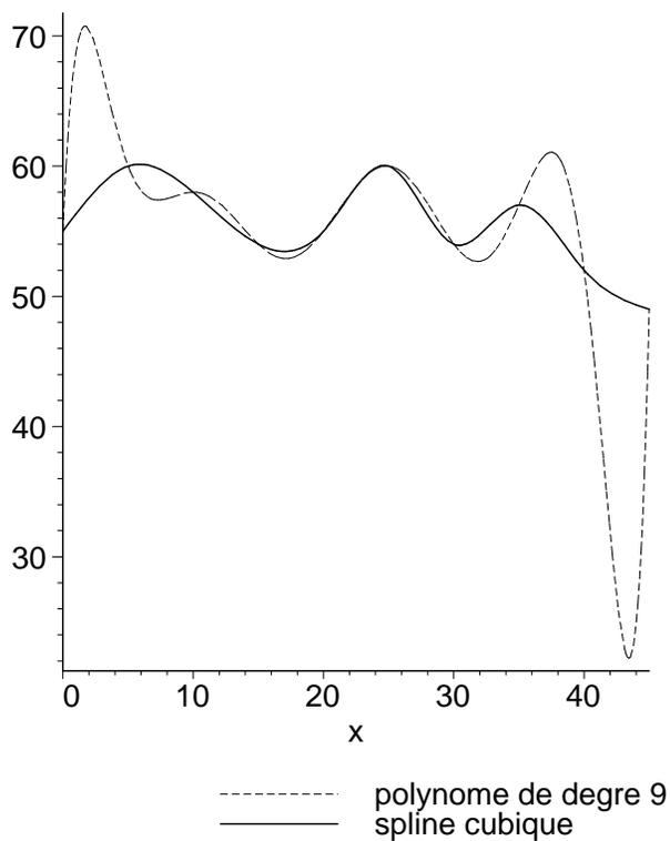
FIG. 8 – Interpolation de  $v$  par un polynôme et par une spline cubique.
