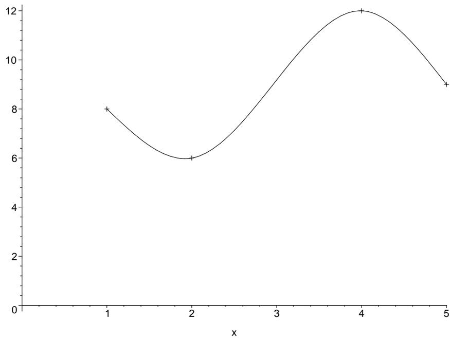
FIG. 7 – Interpolation de  $f$  par une spline cubique.
