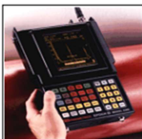
Appareil de contrôle par US
